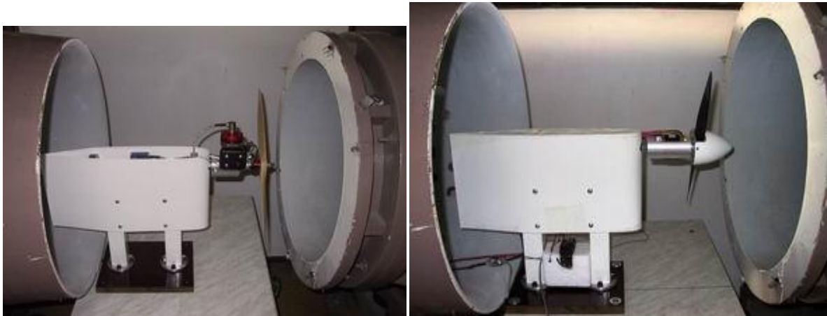
Obr. 1 Měření výkonových parametrů vrtulové pohonné jednotky pro bezpilotní prostředky. Vlevo pohonná jednotka tvořená dvoutaktním spalovacím motorem a vrtulí, vpravo pohonná jednotka tvořená elektromotorem a vrtulí.
