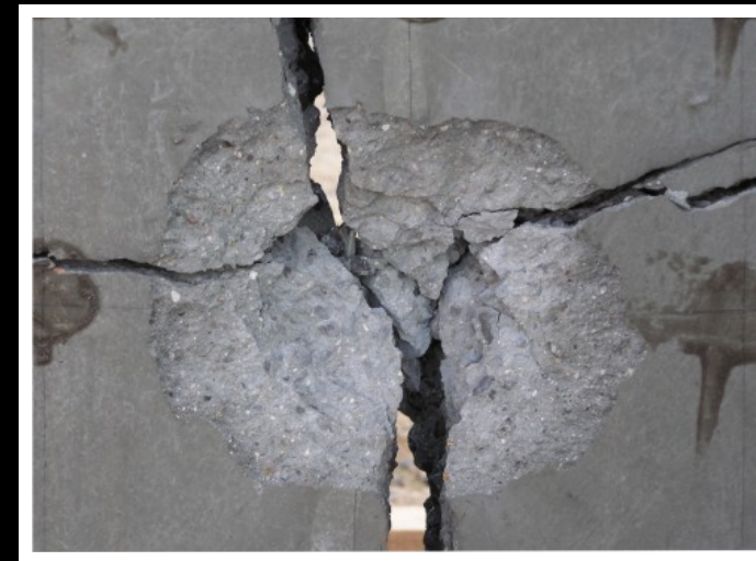
Zkouška betonové desky na kontaktní výbuch 0,5kg TNT
