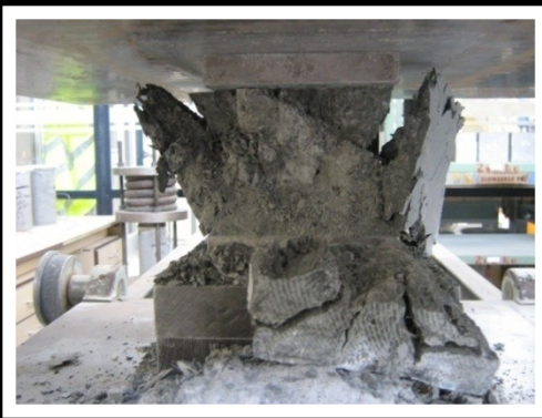
Tlaková zkouška betonu
