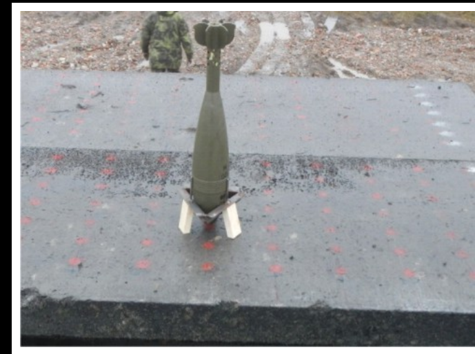
Zkouška UHPC desky
